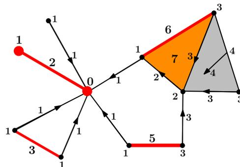
Figura 2: Campo vectorial gradiente inducido por una función de Morse discreta.
