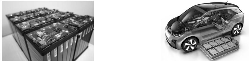
Figura 2: Un *pack de baterías* de forma rectangular, mostrando visiblemente en su parte superior el *BMS* integrado que monitoriza el *pack* (izquierda) [6], y vehículo eléctrico al que se le ha extraído la unidad de alimentación, de la cual se puede apreciar su armazón externo (derecha) [5].
